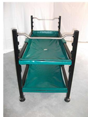
12) Gebogene Inox-Stangen (26) [NSN-6530-12-406-7687](#) in die **Einhängenasen** A (4), B (5) oder C (6) zwischen den Pfosten einhängen. Eine Schocklagerung (Trendelenburg und Anti-Trendelenburg) kann erreicht werden, indem die gebogenen Inox-Stangen zwischen den Pfosten nach oben oder unten verstellt werden.
