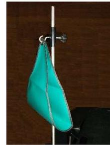
21) Trägerstange, Unterteil verjüngt Inox (37) [NSN-6530-12-406-3275](#) und Trägerstange Oberteil, Doppelhaken und Schraube (36) [NSN-6530-12-406-3271](#) aus dem Koffer nehmen und miteinander verschrauben.
